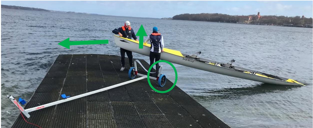
Das Boot auf den Bootswagen ablegen und den Bug runterdrücken, sodass das Heck mit der Finne aus dem Wasser gehoben wird:
