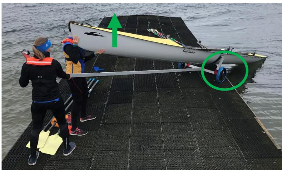
Den Wagen unter dem angehobenen Boot herausziehen. Das Boot ins Wasser heben, da es den Steg **nicht** berühren darf (das Coastal-Boot hat **keine** Kieleiste wie ein Gig-Boot):
