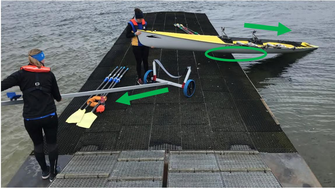
Den Bug seitlich am Schwimmsteg absetzen, dabei darf das Boot **nicht** den Steg berühren, da das Coastal-Boot keine Kieleiste wie ein Gig-Boot hat; den Bootswagen am Handlauf des Stegs oberhalb der Stegrampe abstellen:
