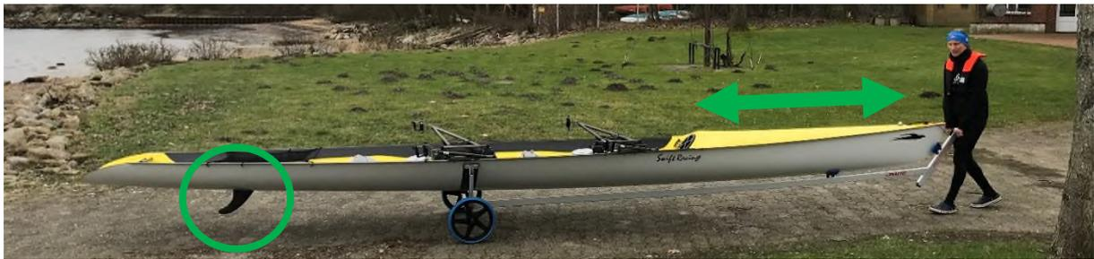
Transport der Coastal-Boote über Stegrampe: Das Coastal-Boot wird auf dem Wagen die Stegrampe vorsichtig runtergerollt. Dabei ist insbesondere bei Niedrigwasser darauf zu achten, dass die Finne nicht die Stegrampe oder den Schwimmsteg berührt! Um eine Berührung zu vermeiden, muss das Heck gegebenenfalls während des Runterrollens des Wagens am Heck angehoben werden.
