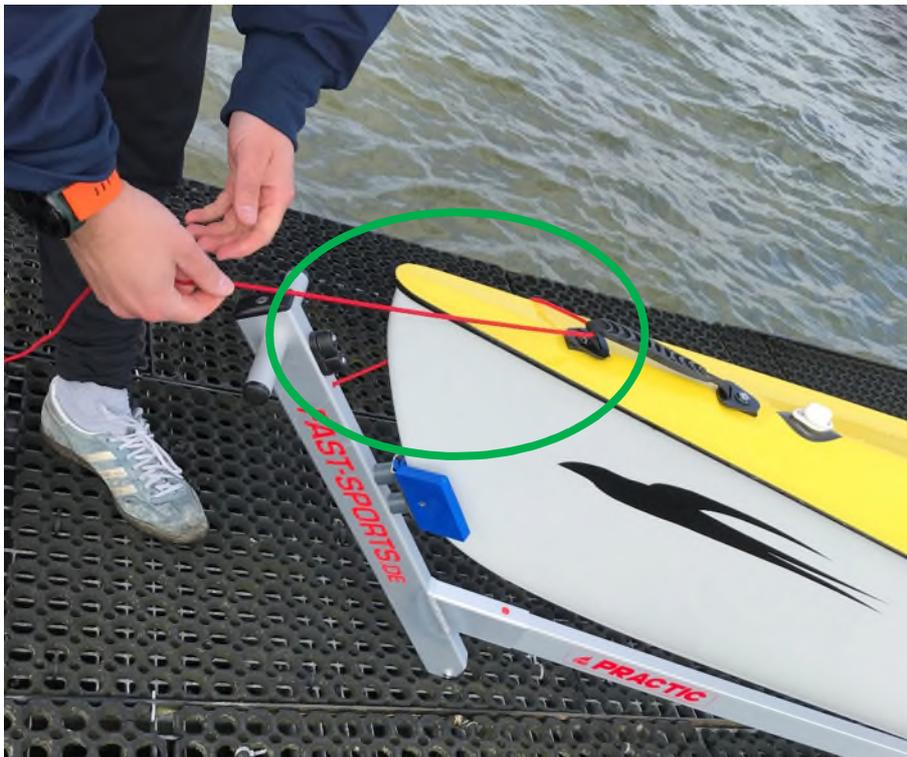
Transport der Coastal-Boote über Stegrampe: Das Coastal-Boot wird auf dem Wagen die Stegrampe vorsichtig hochgezogen. Dabei ist insbesondere bei Niedrigwasser darauf zu achten, dass die Finne nicht die Stegrampe oder den Schwimmsteg berührt! Um eine Berührung zu vermeiden, muss das Heck gegebenenfalls während des Hochziehens des Wagens am Heck angehoben werden.
