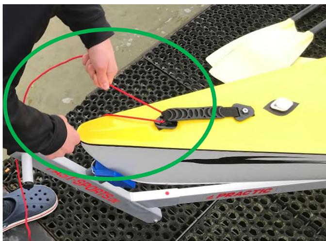
Zu Wasserlassen des Coastal Bootes durch Anheben des Bugs, sodass das Heck aufschwimmt:
